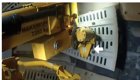
Herramienta INSIDEOUT GrateXtract retirando parrillas “super grate” de Bradken
