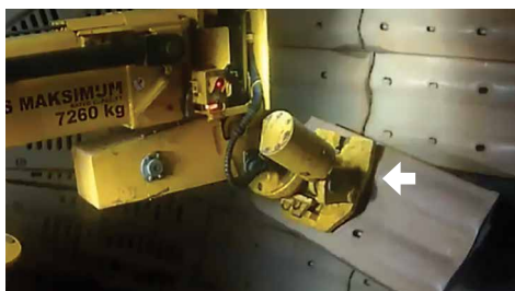
Kit de herramientas INSIDEOUT ShellXtract retirando corazas Bradken del cilindro
