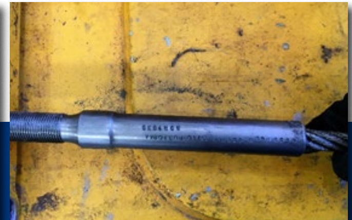
Figura 4: Reemplazo prematuro del tensor crimpado del cable de la pluma de la MRM.
